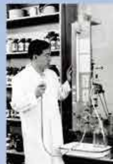
コーネル大学でVan Slyke法(ア ミノ基の定量)の実験を指導する榊 原 俊平 博士 Dr. Sakakibara demonstrating expe riment of the Van Slyke method (for quan tity analysis of amino group) at Cornell
