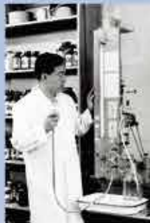
コーネル大学でVan Slyke法(ア ミノ基の定量)の実験を指導する榊 原。Dr. Sakakibara demonstrating expe riment of the Van Slyke method (for quan titative analysis of amino group) at Cornell
